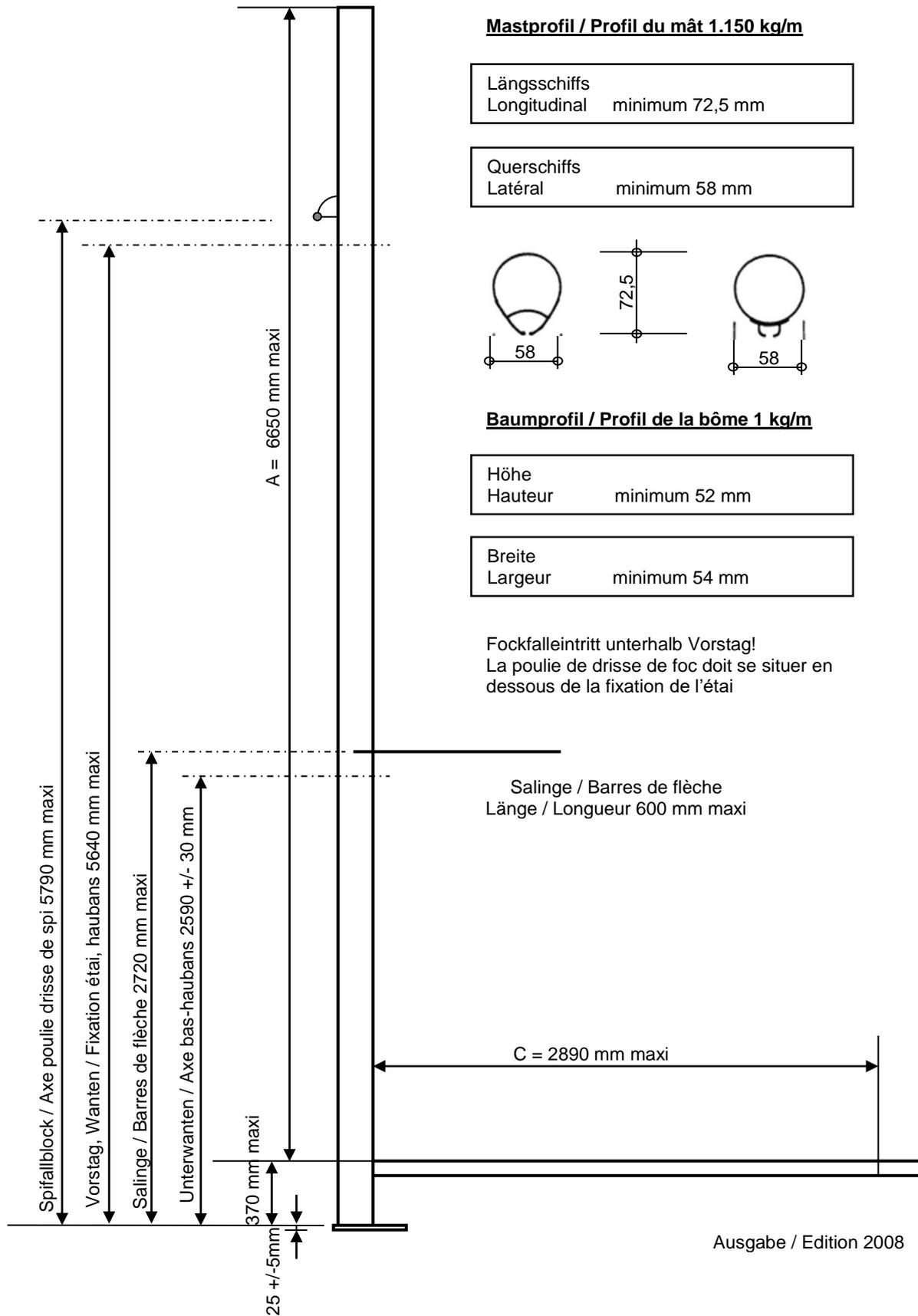
**Mastprofil / Profil du mât 1.150 kg/m**
