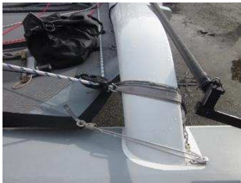
Garcette de maintien en position et pour le démontage
