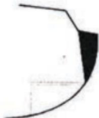
Le renfort sera en contreplaqué marine ou en sandwich composite. Dans ce cas l'âme sera en contreplaqué marine et les peaux en fibres de verre, en alu ou en inox.
