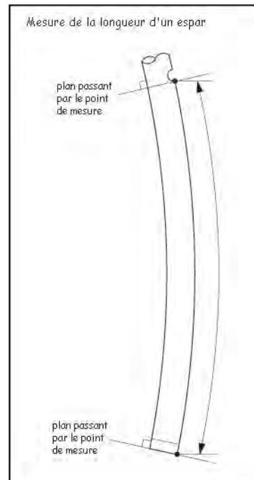
**H.4.2** L'**accastillage**, la flèche et les échantures locales doivent être ignorés lors du mesurage d'un **espar** ou de ses prises de dimensions.
