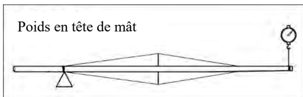
**H.4.7** La **hauteur du centre de gravité** du **mât** doit être vérifiée avec les **drisses** complètement hissées et avec le surplus sur la **marque de limite inférieure** et le **gréement** tendu attaché à l'**espar** aussi proche du **point inférieur** que possible.
